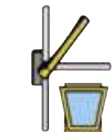
Speciale uitvoering met kierstand ventilatie.
